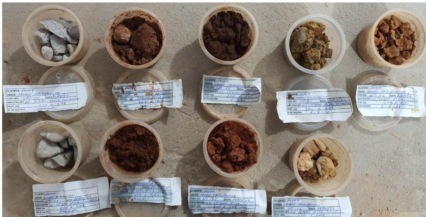
AMOSTRAS REPRESENTATIVAS DOS FUROS: SPT 01 E SPT 02 (VISUALIZAÇÃO: DE BAIXO PARA CIMA /ESQUERDA PARA DIREITA)
